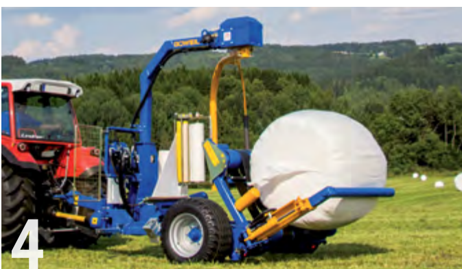
4. Bele zrzucane są ostrożnie do tyłu.
