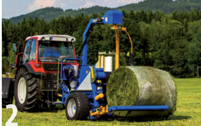
2. Przy pomocy ramienia ładowania bela zostaje podniesiona na stół owijkarki >>
