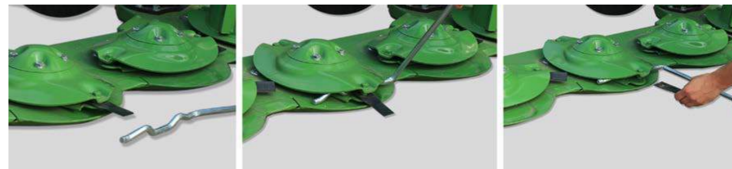
Za pomocą specjalnego klucza, będącego w wyposażeniu standardowym, można przeprowadzić szybką wymianę noży tnących.
